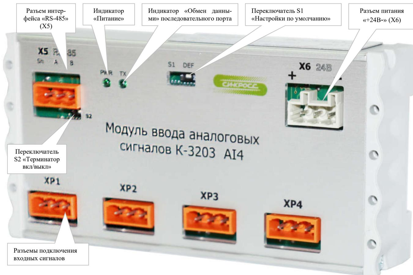
Рисунок 1 - Внешний вид модуля К-3203
