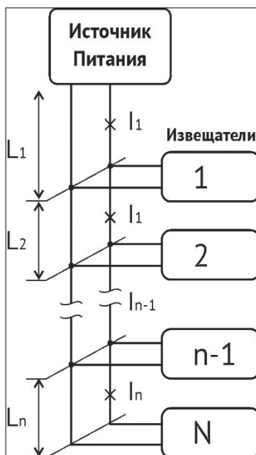
Рисунок Д.8 – Типовая схема подключения ИП к источникам питания
